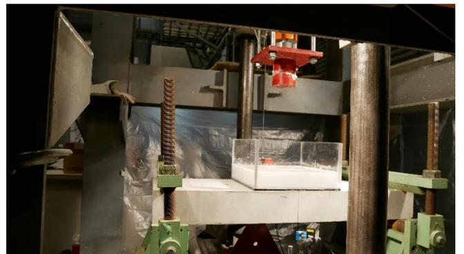
写真2 重錘落下実験の状況
