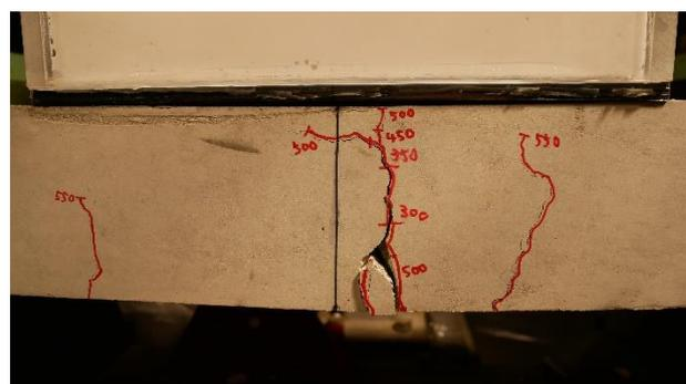
写真 3 ひび割れの様子(上：ゴム
