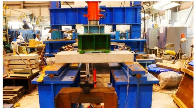
写真1 静的載荷実験の状況
