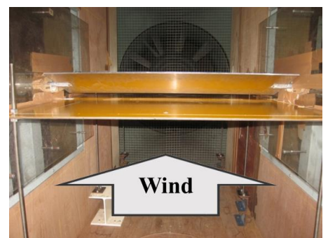
写真-2 模型設置状況(逆風)
