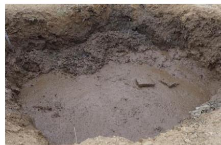
図-1 キレート処理飛灰の性状(泥状)
