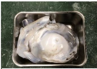
写真4 熱風で溶かした PET (79.9g)
