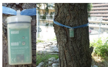
図-2 HOB0ペンダントロガー(onset製UA-002-64)
