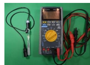
写真-2 デジタルマルチメーターと SCE 照合電極
