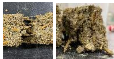
写真-2 曲げ試験供試体の断面の様子
