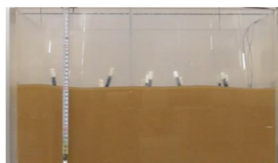
写真-1 実験後のモデル杭の様子 (節あり(13本打設))
