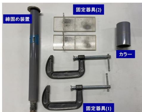
写真-2 作製した締固め装置
