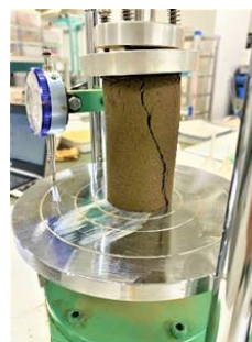
写真-3 破壊形状 1
