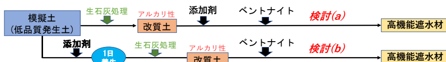
図-2 低品質発生土の処理フロー
