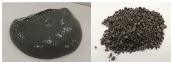
図1 浚渫土(左)と改質材(右)
