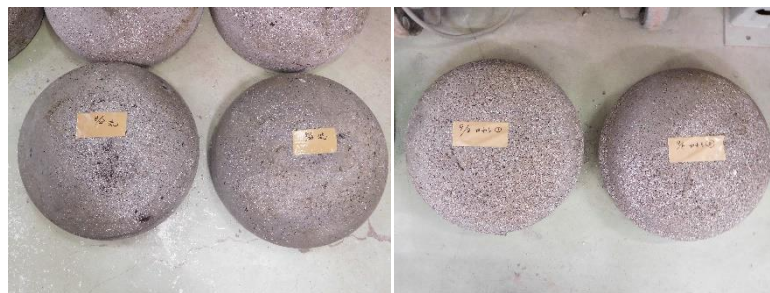
写真-2 今年度作製した藻場基盤材 (左：流動砂，右：廃瓦)
