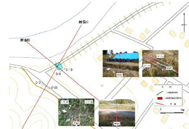
図-5 γ線探査測線位置および断裂分布図(球磨川左岸 55.0k)
