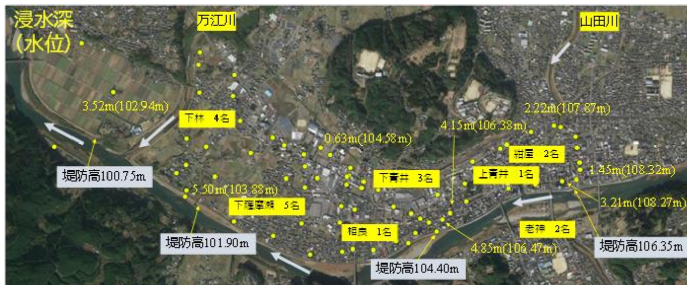
図2 人吉市街地付近の浸水深（水位，TP），堤防標高ならびに地区ごとの人的被害者数
