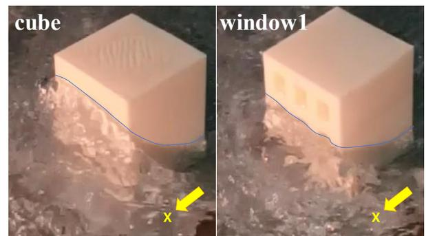
図-6 ビル模型の引き波水位変動比較
