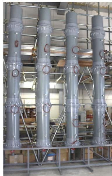
図1 ライシメータ散水実験装置
