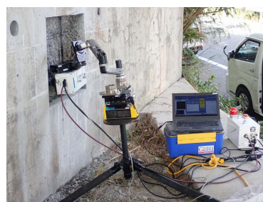
写真-1 X線回折法による鉄筋残留応力測定
