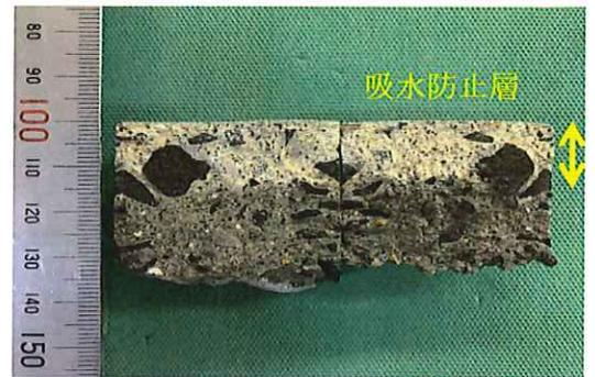
写真-2 吸水防止層の浸透深さ
