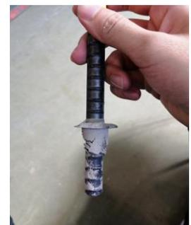
写真-2 引抜き破壊の様子
