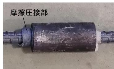
写真-1 モルタル充填継手の外観
