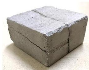
写真8 ひび割れ供試体
