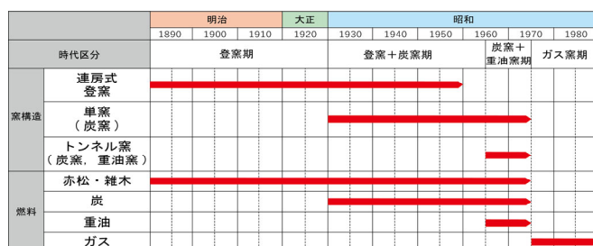
図2 窯の構造と燃料の変遷
