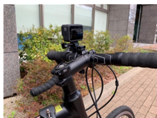
写真1 カメラの 固定状況（予備調査）
