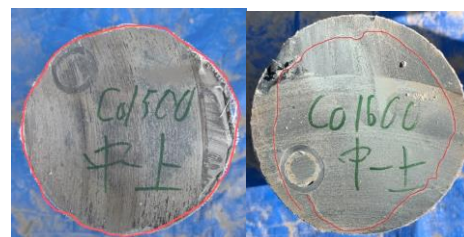
図 4 アンカー体切断面 (実験番号 A(左), B(右))
