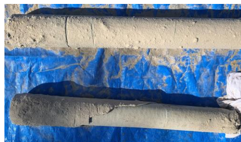
図 3 模型地盤から取り出したアンカー体 (実験番号: A(上) B (下))
