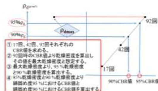
図-2 修正 CBR の算出方法
