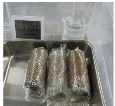
写真-2 供試体の保管方法
