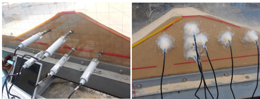
図-4 計測機器の設置状況（左図；テンシオメーター、右図；土壌水分計）
