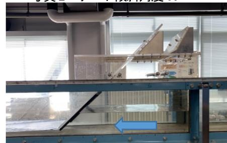
写真3 ゲート傾斜角度  $45^\circ$
