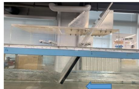
写真2 ゲート傾斜角度  $60^\circ$
