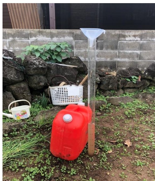
図3 現地浸透試験の様子
