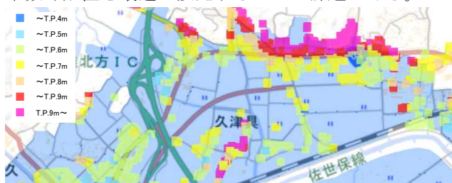
図-5 家屋の浸水調査から推定した浸水位
