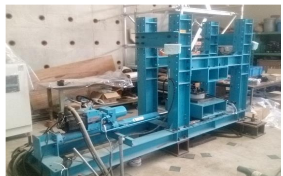
図-2 20kN ハイブリットアクチュエータ
