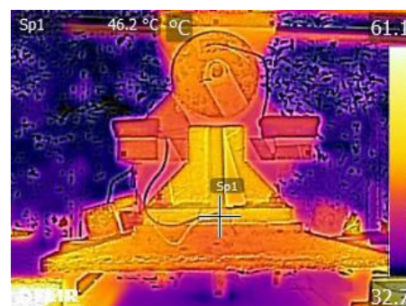
図 1 支承部のサーモグラフィ画像
