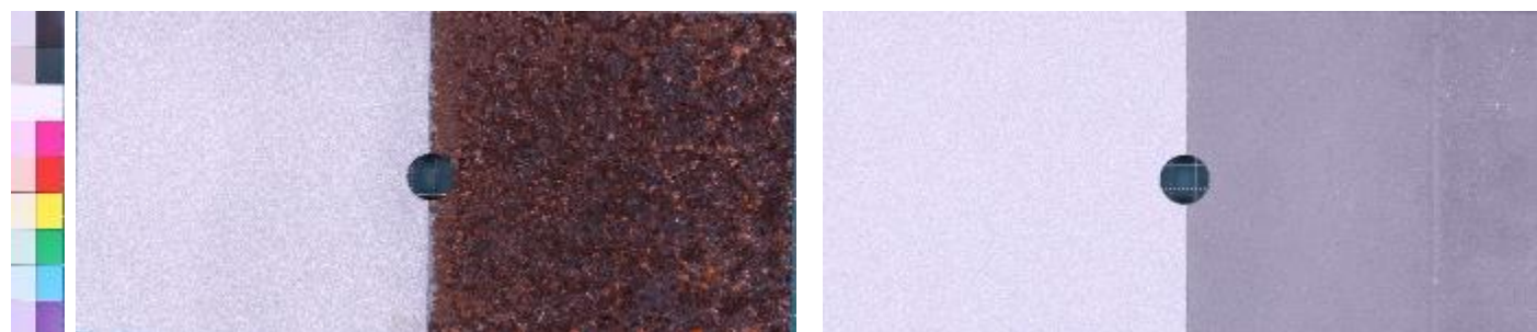
(a) 腐食鋼板
