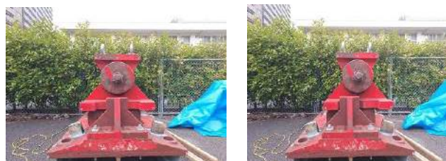
図-4 支承水平方向への変位
