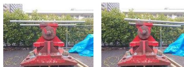
図-5 支承回転方向への変位
