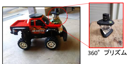
図-4 模擬移動体およびプリズム
