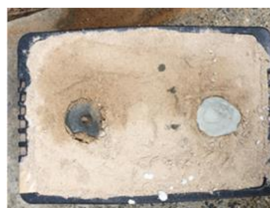
図 2 無加圧浸透試験の模擬地盤
