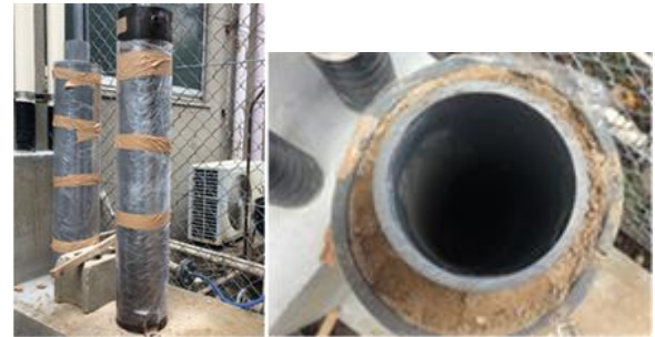
図 3 加圧注入試験の模擬地盤
