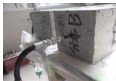
写真-1 圧入状況
