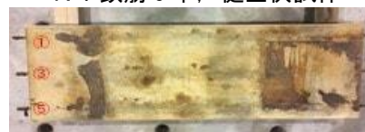
C-1：鉄筋3本，腐食有
