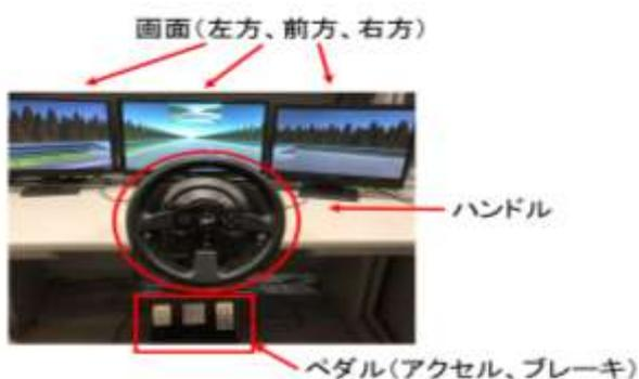
図1 作成したドライビングシミュレータ
