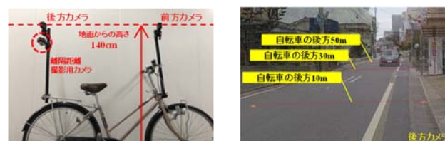
図1 自転車にカメラを搭載した様子 図2 後方カメラの合成映像
