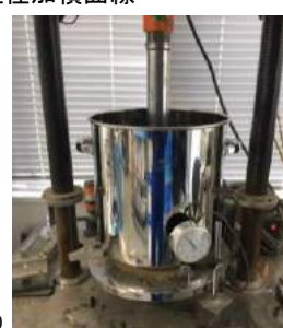
写真-1 水浸 CBR 試験
