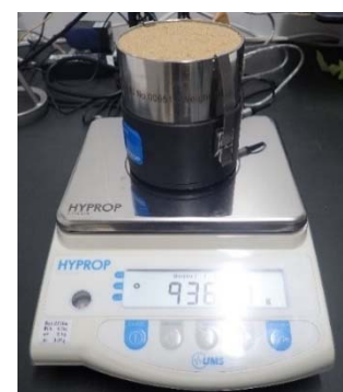
写真3 簡易蒸発法の試験装置 (HYPROP)
