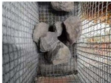
写真-1 実験終了後のドレーン内の様子(豊浦砂)
