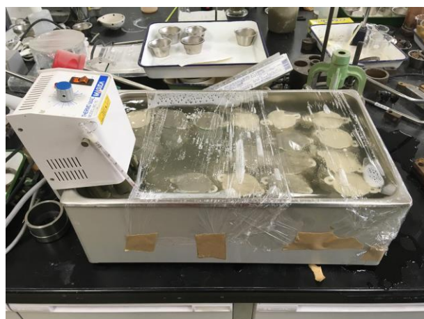
写真-1 温水養生の様子
