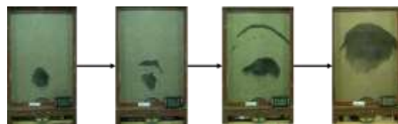
図-3 小西ら 1) による地盤陥没再現実験
