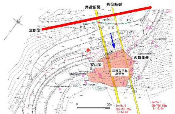
図-8 断層分布と崩壊区間(肌色)の対応(補強土壁)
