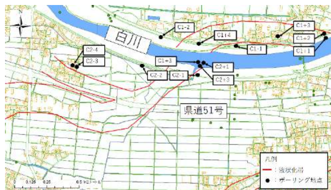
図-3 城山薬師・半田地区の液状化帯
