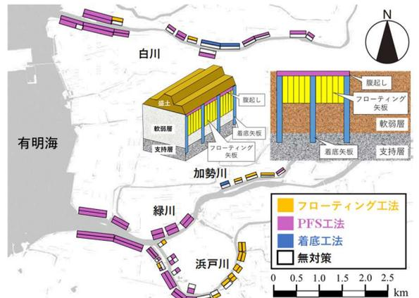
図-1 熊本平野における鋼矢板工法の施工位置
