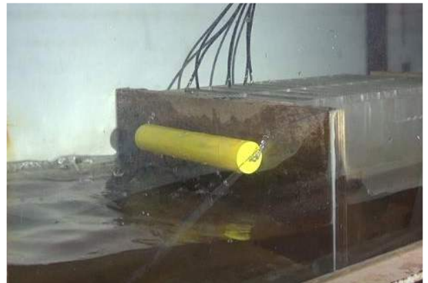
図-1 簡易越波対策工
