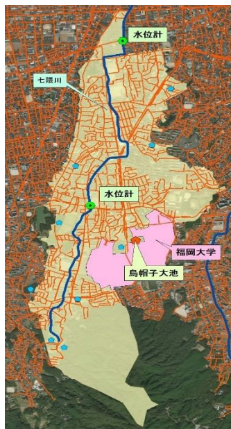
図-4 七隈川流域排水区モデル
