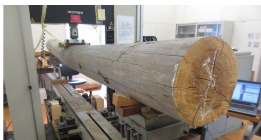
写真-2 曲げ試験の様子
